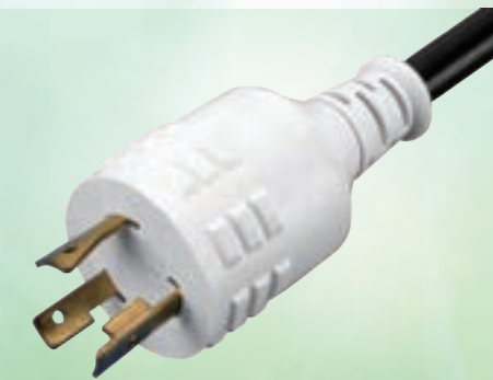
SL-620P (NEMA L6-20P) SJT, SJTW, SJTO, SJTOW 14~10AWG/3C
