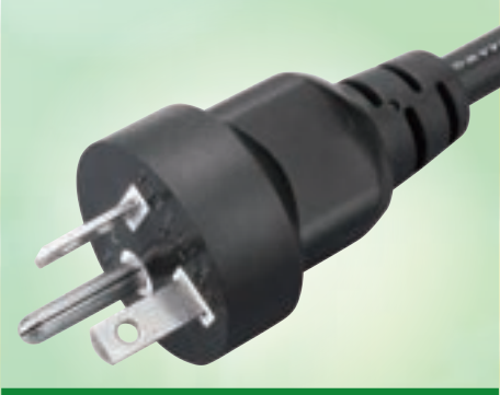
SL-208 (NEMA 5-20P) SJ, SJT, SJTW, SJTO, SJTOW 16~12AWG/3C
