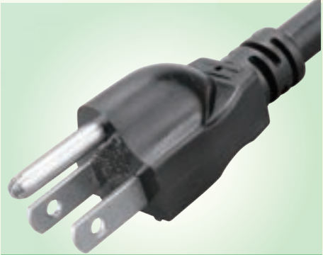
SL-2 (NEMA 5-15P) SVT 18AWG/3C SJT,SJTW,SJTO,SJTOW 18~12AWG/3C ST,STW,STO,STOW 18~16AWG/3C
